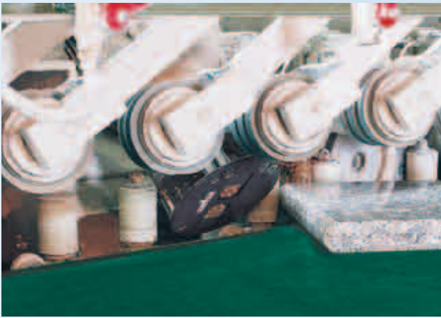
Rundprofilbearbeitung mit 2 Stockwalzen. Bullnose bushhammering with 2 rollers.
